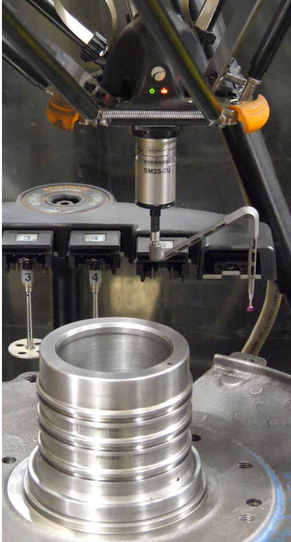
3D 프린팅 맞춤형 스타일러스를 채용한 Equator 300에서 자동차 구성품 검사
