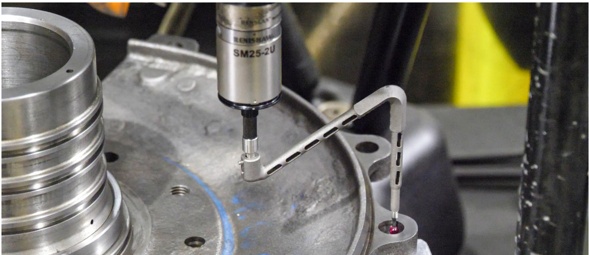
RenAM 500Q 시스템에서 금속 3D 프린팅으로 제작된 맞춤형 스타일러스
