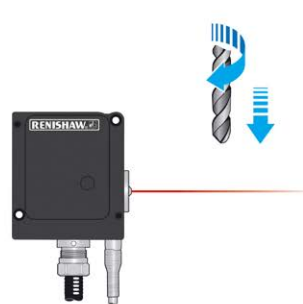
由 ToolWise™ electronics 電子元件 分析反射光
